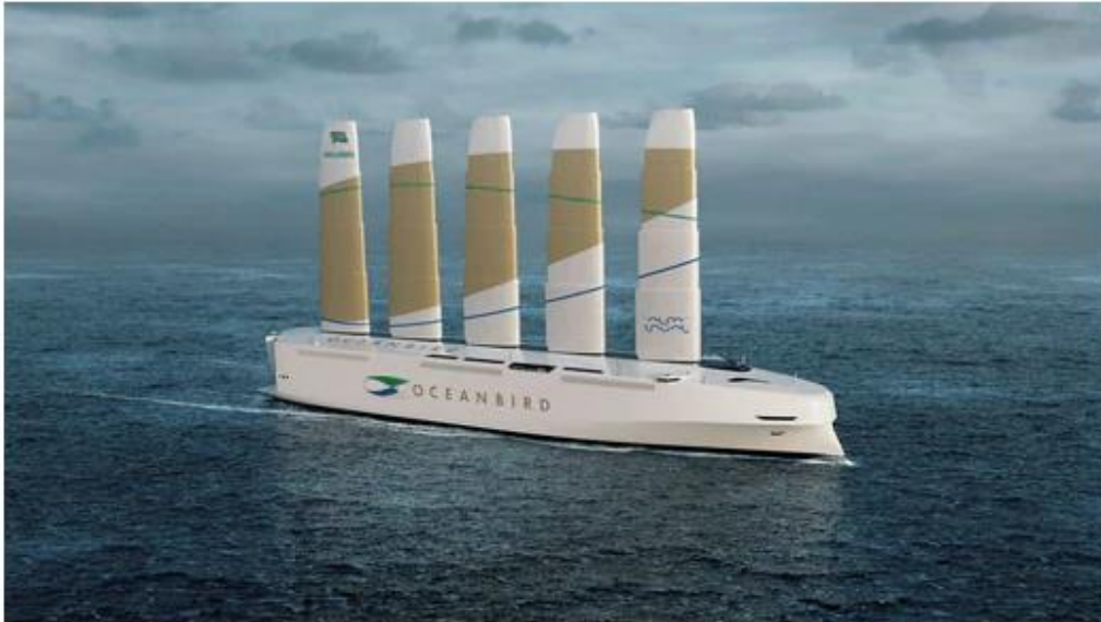
Svenska företagen Wallenius och Alfa Laval driver ett av projekten kring klimatneutrala transporter. 2021 presenterade man "Oceanbird", som ska bli ett 200 meter långt fartyg med 80 meter höga "segel" för att ta sig fram ljudlöst och nästintill utsläppsfritt. Foto: Cover Images
